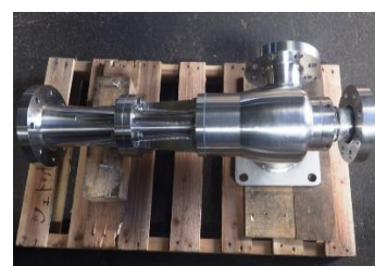
排水用ジェットポンプ製作
