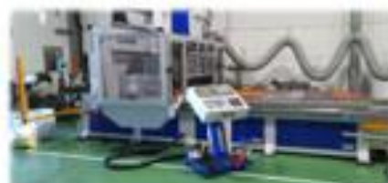
NC ルーター (切削自動加工機 CAD-CAM 3D 5 軸搭載)
