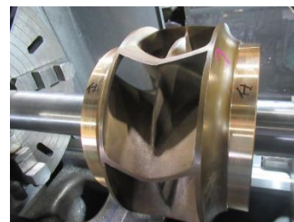
浄水場ポンプインペラ加工
